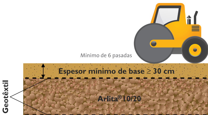
Figura 27. Compactación de capa de coronación.
